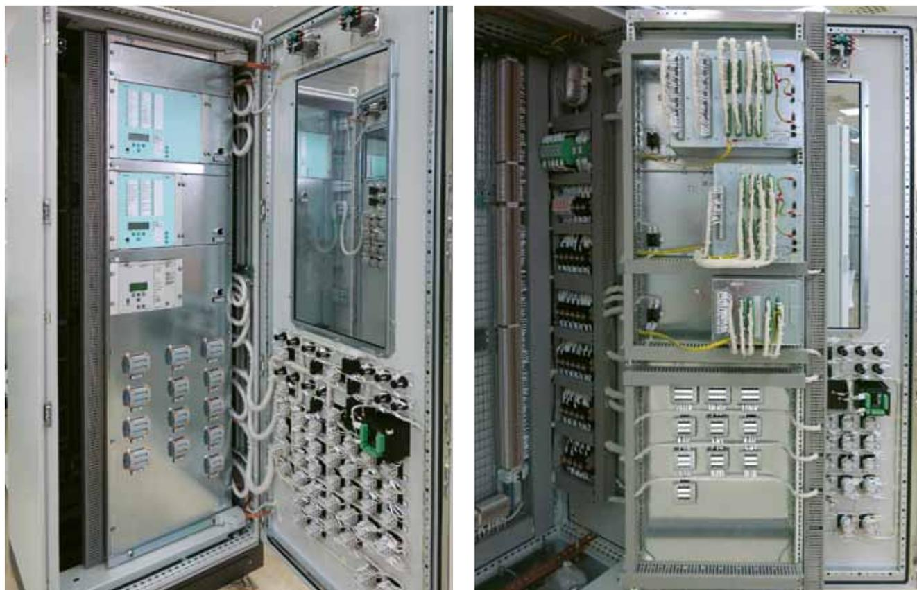
При заказе устройств РЗА одностороннего обслуживания изготавливаются шкафы с поворотной рамой, на которой устанавливаются микропроцессорные терминалы и аппараты. Для монтажа и обслуживания клеммников шкафа, установленных на задней стенке, передняя дверь шкафа и поворотная рама открываются. Максимальный угол открытия поворотной рамы составляет 130 градусов. Поворотная рама оснащена двухточечным фиксатором.
